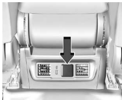
Parte trasera de tomacorriente de consola central.
