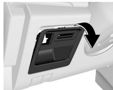
Caja de fusibles interior
