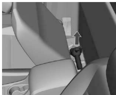
Ubicación del gato y herramientas en la cabina regular.
